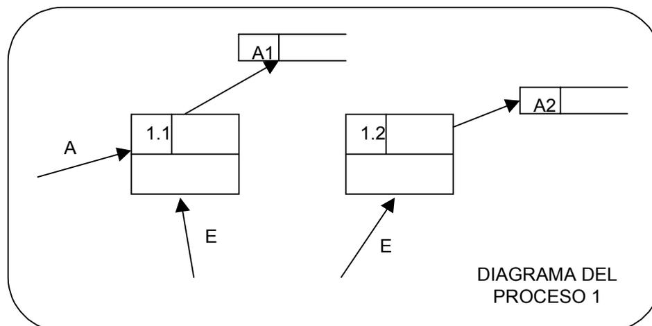
Además, hay otra inconsistencia respecto al almacén A1: en el diagrama del nivel anterior, el proceso 1 se conectaba con un flujo de entrada-salida este almacén, cosa que no se refleja en el diagrama de este proceso, en el que sólo aparece uno de entrada.
