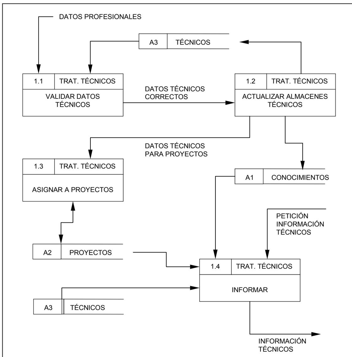
Para la validación, el proceso 1.1 Validar Datos Técnicos obtiene información del almacén A3 Técnicos y genera una salida, el flujo Datos Técnicos Correctos, que lleva los datos válidos a la función 1.2 Actualizar Almacenes Técnicos. Esta función se encarga de actualizar los almacenes A3 Técnicos y A1 Conocimientos, pero también emite un flujo al proceso 1.3 Asignar a Proyectos. Éste se encarga de hacer asignaciones de técnicos en el almacén A2 Proyectos.
