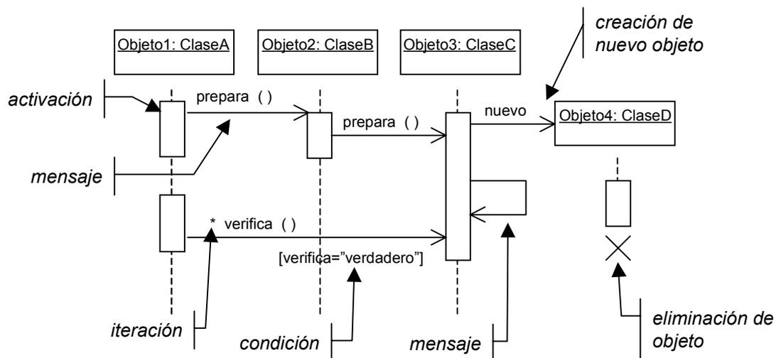
Los mensajes pueden presentar también condiciones e iteraciones. Una condición se representa mediante una expresión booleana encerrada entre corchetes junto a un mensaje, e indica que ese mensaje sólo es enviado en caso de ser cierta la condición. Una iteración se representa con un asterisco y una expresión entre corchetes, que indica el número de veces que se produce.
