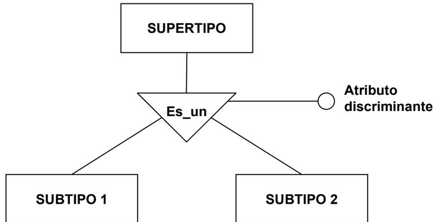
En el triángulo se representará: con una letra **d** el hecho de que los subtipos sean disjuntos, con un círculo **O** si los subtipos pueden solaparse y con una **U** el caso de uniones por categorías. La presencia de una jerarquía total se representa con una doble línea entre el supertipo y el triángulo.
